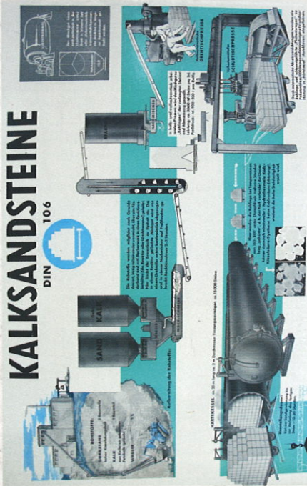
Gezeigt wird die Entwicklung der Produktionstechnik anschaulich anhand der eingebauten Maschinen von 1909, 1936, 1959/1961.
