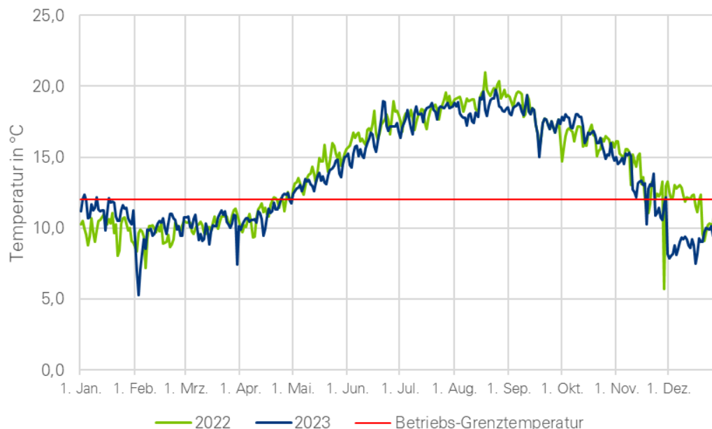
Abbildung 39: Kläranlage Roding - Grenztemperatur und Temperatur
